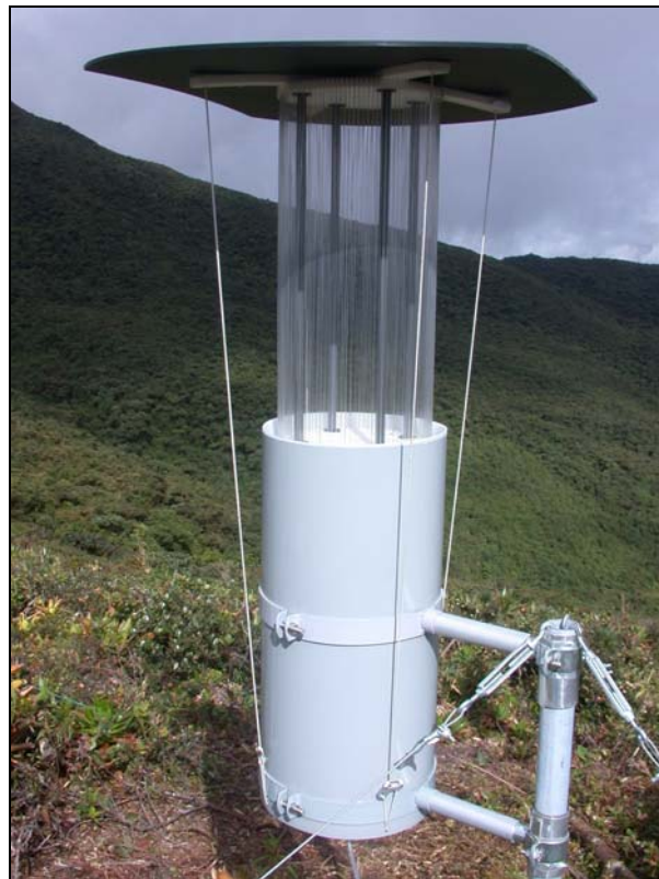
Abbildung 10: zylindrischer Nebelsammler (CFC) (Quelle: R ROLLENBECK)
