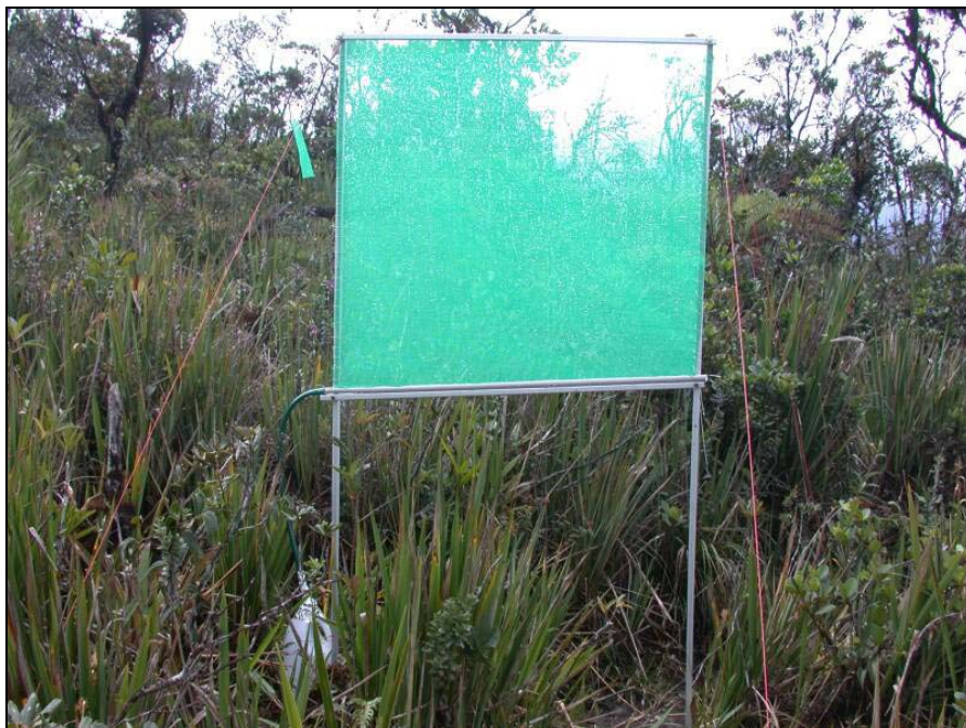
Abbildung 11: Standardnebelfänger (SFC) (Quelle: R. ROLLENBECK)
