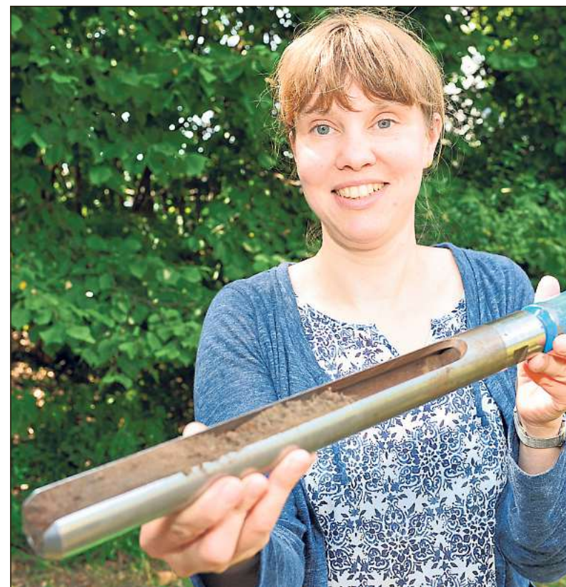
Proben bis zu einer Tiefe von 30 Zentimetern kann die Forscherin Dr. Ute Hamer mit diesem Spezialgerät nehmen. Bilder: Evers
