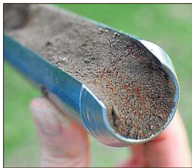
Detailsicht: Im Boden zeigen sich feine rostbraune Einsprengsel – es sind Eisenablagerungen.
