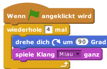
Abbildung 3: Beispiel für die Nutzung der Kontrollstruktur „Zählzyklus“, um die Scratch®-Katze sich um 360° im Uhrzeigersinn drehen und dabei für jede Drehung um 90° ein „Miau“ ertönen zu lassen (erstellt mit scratchblocks 3.4, https://scratchblocks.github.io/ , zuletzt geprüft am 13.10.2020)
