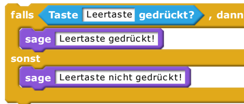
Abbildung 2: Beispiel für die Nutzung der Kontrollstruktur „Verzweigung“ zur Feststellung eines Tastendrucks (hier: Leertaste) in Scratch® 2.0 (erstellt mit scratchblocks 3.4, https://scratchblocks.github.io/ , zuletzt geprüft am 13.10.2020)
