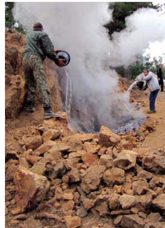
Охлаждане на скалата, преди да започне добивът от кварцовата жила.
