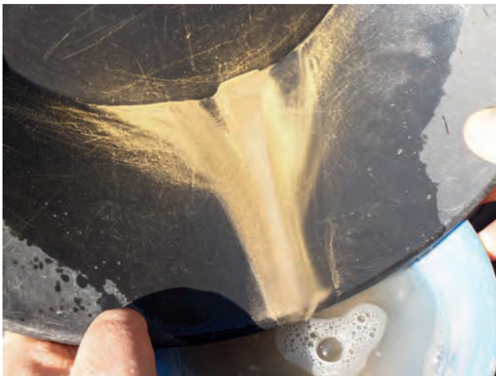
Обр. 11. Промиване на рудния концентрат. Златото се появява на дъното на панера
