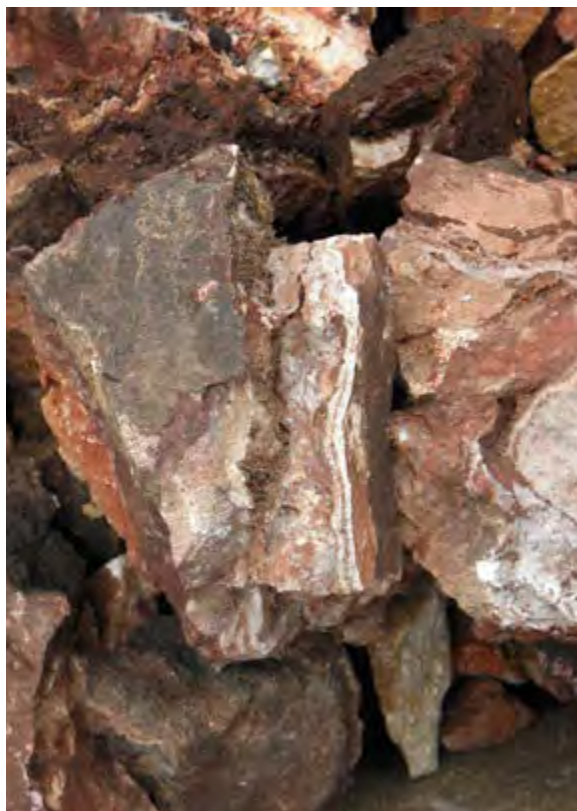
Обр. 9. Добити след процеса на нагряване късове от кварц-адуларовата жила. Рудни образци с високо съдържание на злато
