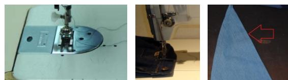
Unter der Nadelplatte ist die **Spule** für den **Unterfaden**, von oben kommt der **Oberfaden**.
