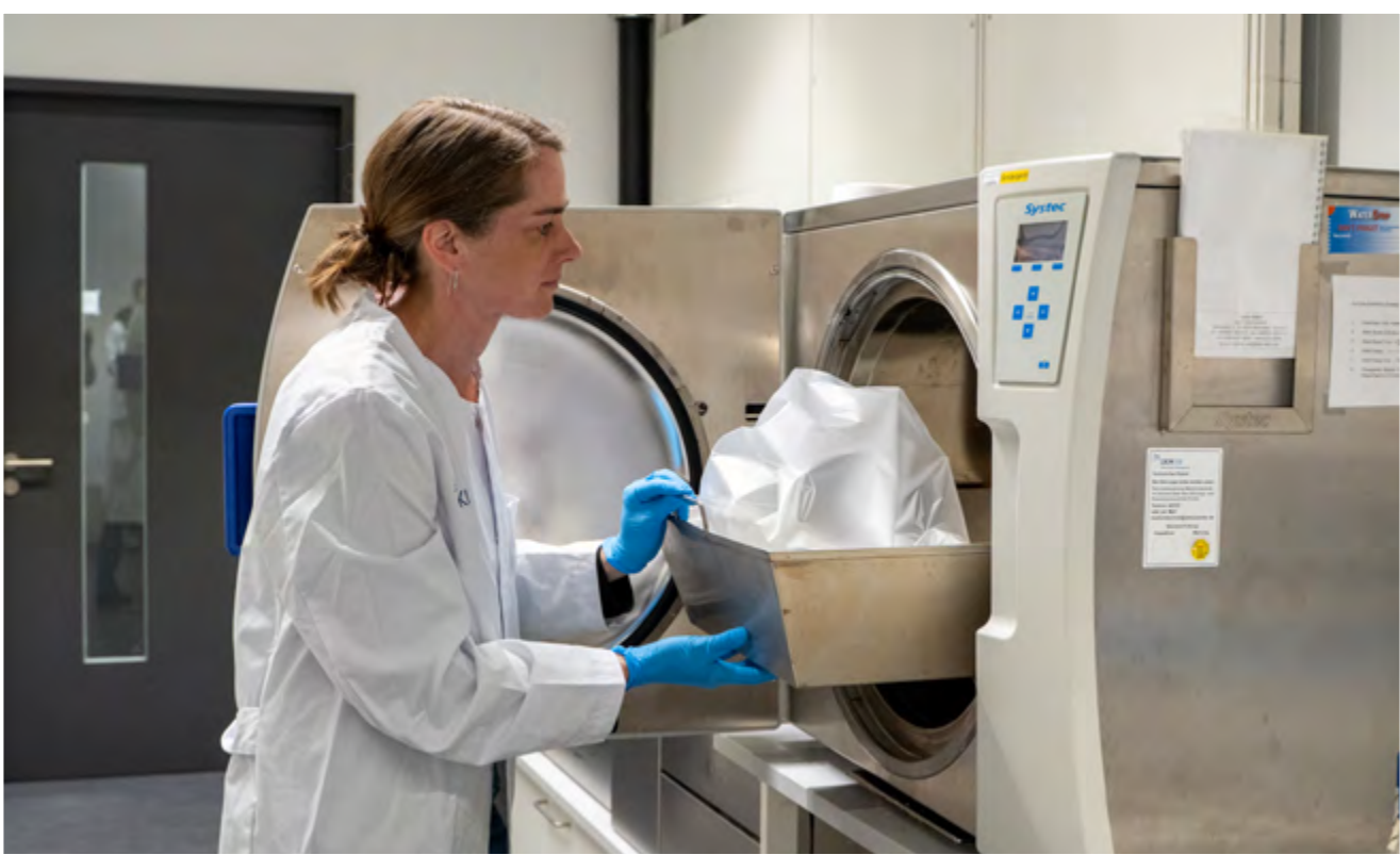
Dr. Sonja Schelhaas und ihre Kolleginnen und Kollegen im MC nutzen Druck und Hitze, um beispielsweise Zellen und Bakterien in Autoklaven für eine unbedenkliche Entsorgung zu inaktivieren.
