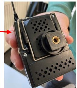
Öffnen Sie nun die große vordere Klappe des Empfängers und setzen Sie 2 AA-Batterien in die vorgesehenen Slots. Der Empfänger sollte daraufhin direkt angehen (ansonsten länger auf den On/Off-Knopf über dem Batteriefach drücken).
