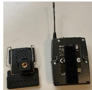
Befestigen Sie den Clip mit dem Eisendraht am Empfänger, in dem Sie die Ärmchen in die Löcher des Empfängers bugsieren. Hier ist Geduld gefragt.
