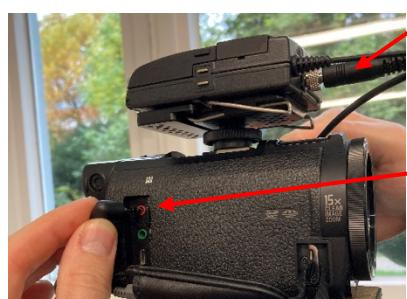
Jetzt können Sie das beiliegende Kabel mit der schraubbaren Seite in den Empfänger und der anderen Seite in den pinkfarbenen Anschluss in der Kamera stecken.
