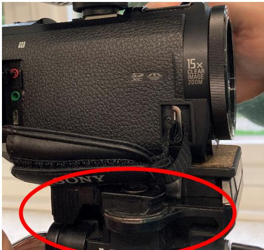
Nach dem stabilen Aufbau des Stativs wird die Kamera auf dem Stativ montiert und an die Stromversorgung angeschlossen werden, ggf. mit Kabeltrommel.
