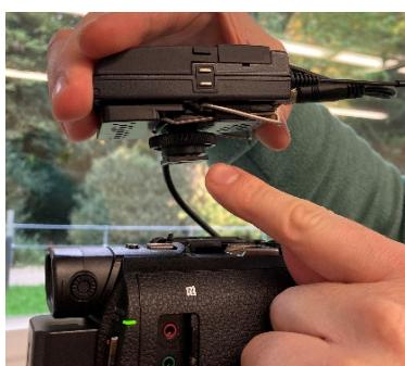
Nachdem Sie oben auf der Kamera die Klappe für den Blitzschuh geöffnet haben, schieben Sie die Halterung des Empfängers in den an der Kamera befindlichen silbernen Blitzschuh. Ist die Halterung bis zum Anschlag eingeschoben, drehen Sie die Schraube fest an, sodass der Empfänger nicht mehr rausfallen kann.
