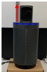
Starten Sie die Kandao-Kamera, in dem Sie relativ kräftig auf den inneren Kreis oben auf der Kamera drücken. Daraufhin fährt die Kamera aus dem Gerät hoch, die Kamera ist nun eingeschaltet.
