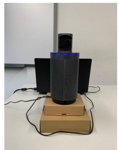
KandaoMeeting wird mit zwei Kabeln angeschlossen. Das eine ist für die Stromversorgung, das andere dient der Verbindung mit dem eigenen Notebook.
