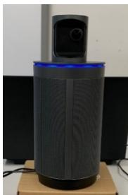
Starten Sie die Kandao-Kamera, in dem Sie relativ kräftig auf den inneren Kreis oben auf der Kamera drücken. Daraufhin fährt die Kamera aus dem Gerät hoch, die Kamera ist nun eingeschaltet.
