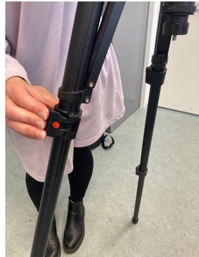
Nach dem Lösen des Schwenkstoppers (4) können Sie mithilfe des Schwenkgriffs das Kopfteil in die passende Position nach rechts bzw. links bewegen. Zusätzlich ist durch den zweiten Schwenkstopper (3) die Möglichkeit einer Nachjustierung des Winkels gegeben.
