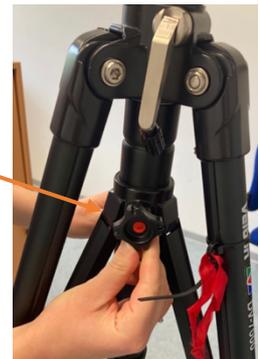
Daraufhin lösen Sie die sechs Beinverriegelungshebel (2), sodass sich die Beine auf die gewünschte Höhe einstellen lassen.
