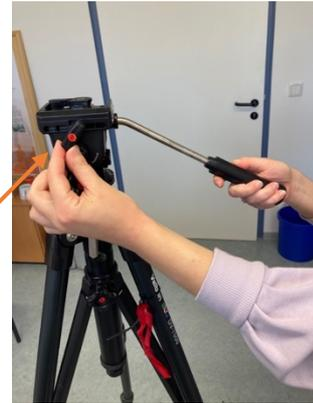
Um die Stativkopfhöhe zu variieren, muss die Kurbel (5) gelöst werden.
