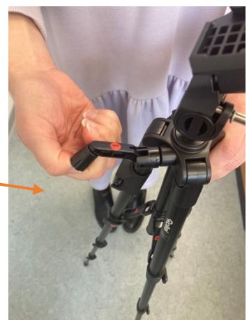
Durch das Drehen an der Arretierschraube (5) lässt sich die Position der Schnellwechsel-/Basisplatte vertikal oder horizontal verändern. Um die Arretierschraube (5) zu fixieren, drehen Sie diese wieder fest zu. Um den Kamerakopf in die gewünschte Neigung (hoch oder runter) zu bewegen, lösen Sie den Handgriff. Ist der gewünschte Winkel erreicht, wird der Handgriff wieder festgezogen.
