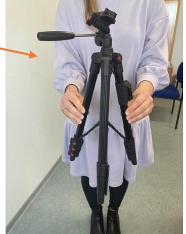
Um die Beinlänge zu verändern, öffnen Sie die Klemmen (2), somit können Sie die Beine auf die gewünschte Länge anpassen. Anschließend werden die Klemmen (2) wieder verschlossen.
