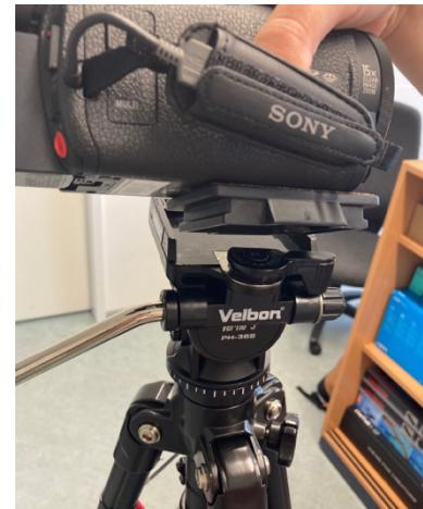
Zum Abschluss drücken Sie den Einspanner wieder in die Ursprungsposition direkt an die Halterung (auf der linken Seite), um die Kamerahalterung zu fixieren.
