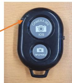
Aktivieren Sie die Bluetooth-Verbindung auf Ihrem Smartphone/ Tablet und wählen das Gerät „Rollei Smart BT“ aus. Während des Verbindens blinkt das grüne Licht der Statusanzeige auf der Fernbedienung. Nach erfolgreicher Verbindung schaltet sich das grüne Licht der Statusanzeige aus und die Fernbedienung kann verwendet werden.
