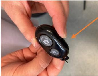
Schalten Sie die Fernbedienung ein, indem Sie den Schalter „ON“ an der rechten Seite drücken.
