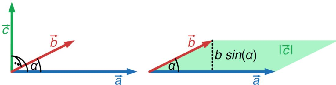
$|\vec{c}|$  ist die Fläche des von  $\vec{a}$  und  $\vec{b}$  aufgespannten Parallelogramms.
