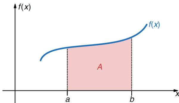
Hierzu kann man die Fläche annähern, indem man sie in Rechtecke zerlegt. Wir zerlegen das Intervall  $[a, b]$  in  $n$  Intervalle der Breite  $h = \frac{b-a}{n}$ . Die Anfangs- und Endpunkte liegen dann bei  $x_j = a + jh$ ,  $j = 0, \dots, n$  und es gilt  $x_0 = a$  und  $x_n = b$ .
