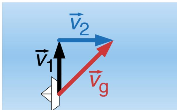
Andererseits: Um sich relativ zum Ufer mit der Geschwindigkeit  $\vec{v}_g$  zu bewegen, muss es relativ zum Wasser mit der Geschwindigkeit  $\vec{v}_1 = \vec{v}_g - \vec{v}_2$  bewegen.
