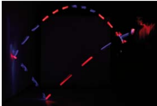
Schüler können die eigene Digitalkamera zur Analyse von Bewegungen einsetzen; gezeigt ist im Beispiel die Langzeitbelichtung eines blinkenden Flummis. Students can take their own long-exposure photographs using digital cameras. The image above shows the long exposure of a flashing bouncing ball.
