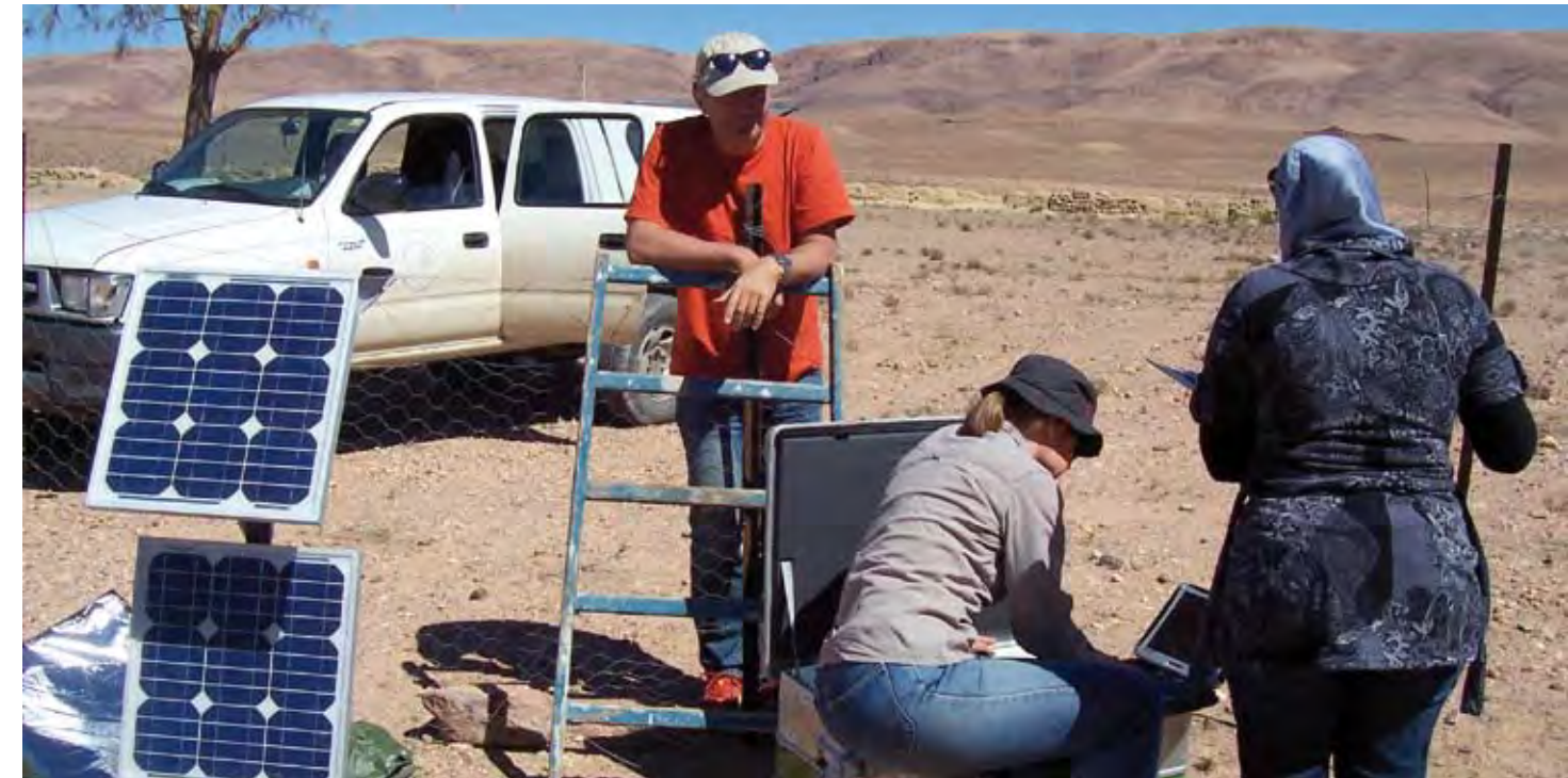
Aufbau einer seismischen Station in Marokko (im hohen Atlas) als Teil des Münster-Marokkoarrays. Der Sensor, Datenlogger, die GPS Antenne sowie die Solarzellen müssen installiert werden. Deployment of a seismic station in Morocco (High Atlas region) as part of the Münster-Morocco array. Sensor, data logger, GPS antenna and solar panels have to be installed.
