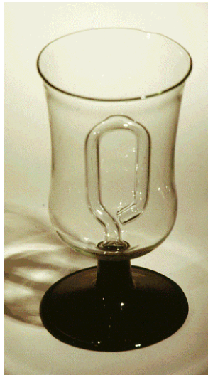
Abb. 2: Besser wäre es, wenn der "Mechanismus" in der Wandung des Gefäßes versteckt ist, wie hier durchsichtig an einem Prototyp demonstriert.
