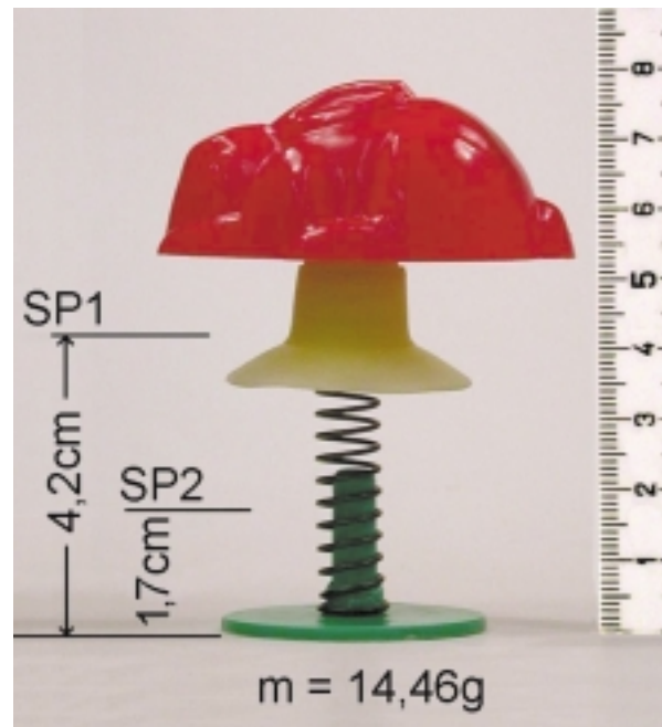
Abb. 2 Das Springspielzeug. SP1 und SP2 bezeichnen die Lage des Schwerpunkts im entspannten und zusammengedrückten Zustand.
