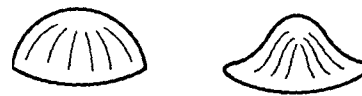
Abb. 5: Springende Gummikappe, a) in stabiler, b) in umgestülpter, metastabiler Lage kurz vor dem "Phasenübergang".
