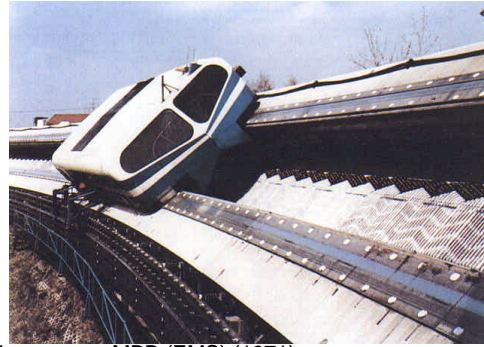
Abb. 2: Vorläufer des Transrapid: (a) Das Prinzipfahrzeug von MBB (EMS) (1971); (b) Der Erlanger Erprobungsträger EET (EDS) (1974)
