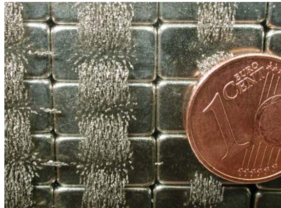
Abbildung 7: Ein etwa 30x30 mm 2 großer Ausschnitt der Magnetplatte, der mit Eisenfeilspänen bestreut ist (Münze als Größenvergleich)
