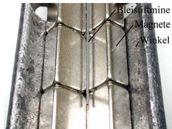
Abbildung 12: Magnetwinkel mit frei schwebender Bleistiftmine aus Graphit
