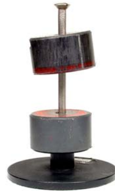
Abbildung 2: Mechanisch stabilisierte Magnete
