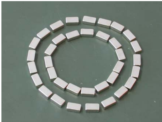
Abbildung 15: Kreisförmig gelegte NdFeB-Magnete, die alle gleichgepol sind
