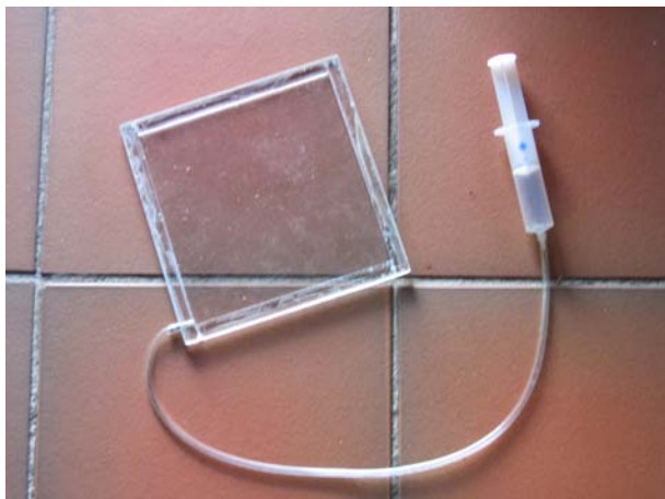
Abb. 14. Zwei Plexiglasscheiben auf Abstand zusammengeklebt als Modell einer Doppelglasscheibe. Mit einer Einwegspritze kann in definierter Weise Luft herausgepumpt werden.
