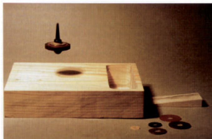
Abb. 1. Der magnetische Kreisel Levitron schwebt in etwa 3 cm Höhe frei über einem Holzkästchen. Die kleinen Ringe dienen zum genauen Austarieren des Kreiselgewichts, mit dem Keil stellt man das Holzkästchen waagrecht auf.
