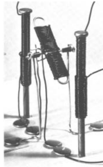
Bild 3: Ein Elektromotor nur aus Draht. nicht gerade auf der Hand. Hinzu kommt, dass die Vorbereitung des Versuchs manchmal umfangreiche Bastelarbeiten erfordert. Man denke etwa an einen lediglich aus Büroklammer und Kupferdraht hergestellten Elektromotor (Bild 3). Von der Freihändigkeit bleibt in diesen Fällen allenfalls die Alltäglichkeit und Schlichtheit des Materials, die Überschaubarkeit der Konstruktion sowie die Einfachheit der Durchführung des eigentlichen Versuchs 3 .
