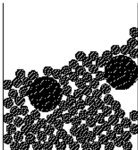
Bild 1: Wenn ein Gemisch von großen und kleinen Kugeln rhythmisch geschüttelt wird, landen schließlich die großen Kugeln oben. (Momentaufnahmen von oben links nach unten rechts).
