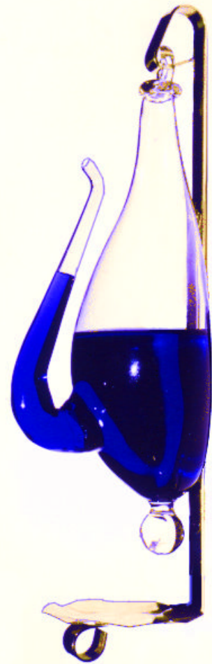
Abb.1: Ein typisches Goethe-Barometer. Im bauchigen Gefäß befindet sich Wasser. Die Höhe des Wasserspiegels im Schnabel zeigt den Luftdruck an. Ein Tropfenfänger dient zum Schutz bei überlaufendem Wasser.
