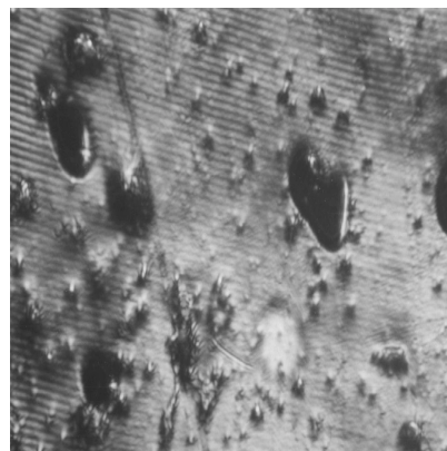
Bild 3: Mikroskopaufnahme eines Fleckes des Glitzerstickers durch den die Farberscheinungen hervorgerufen werden (ca. 1000-fach vergrößert)
