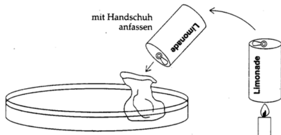
Bild 5: Die dampfgefüllte Getränkedose implodiert, sobald sie mit Wasser in Berührung kommt.
