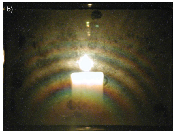
Abb. 3 Farbringe um den Reflex einer Kerzenflamme auf einem verstaubten Spiegel (a). Unter gewissen Blickwinkeln liegt das Zentrum der Farbringe nicht im Mittelpunkt des Farbkreises (b).
