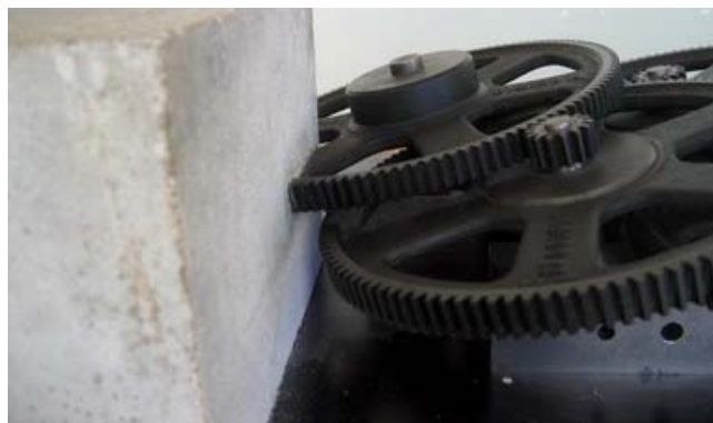
Abb. 6: Eine Bewegung wird mit Hilfe von Zahnrädern unendlich langsam gemacht (Phaeno (Wolfsburg)).
