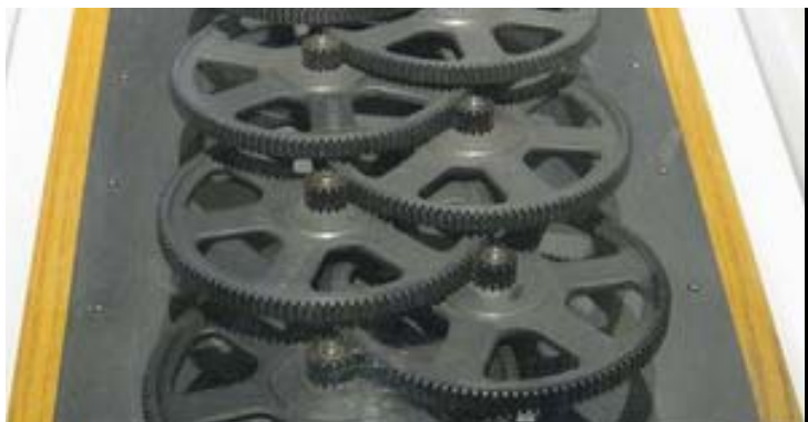
Abb. 6: Eine Bewegung wird mit Hilfe von Zahnrädern unendlich langsam gemacht (Phaeno (Wolfsburg)).
