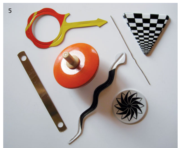
Abb. 2 Ein Draht, der an der Spitze eines Magnetkreisels anliegt, vollführt entlang seiner Längsachse eine Hin- und Herbewegung. Außerdem dreht er sich ruckweise um seinen Reibungsschwerpunkt, ähnlich wie ein Uhrzeiger.
