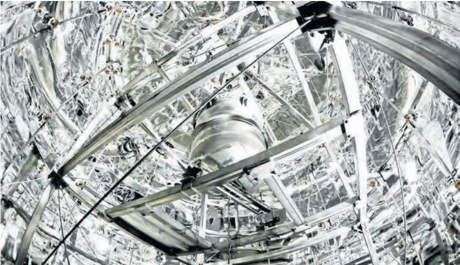
Das Herzstück des imposanten Experiments: Zu sehen ist ein zylinderförmiger Kryostat, der an einer Stahlkonstruktion inmitten eines riesigen Wassertanks hängt.
