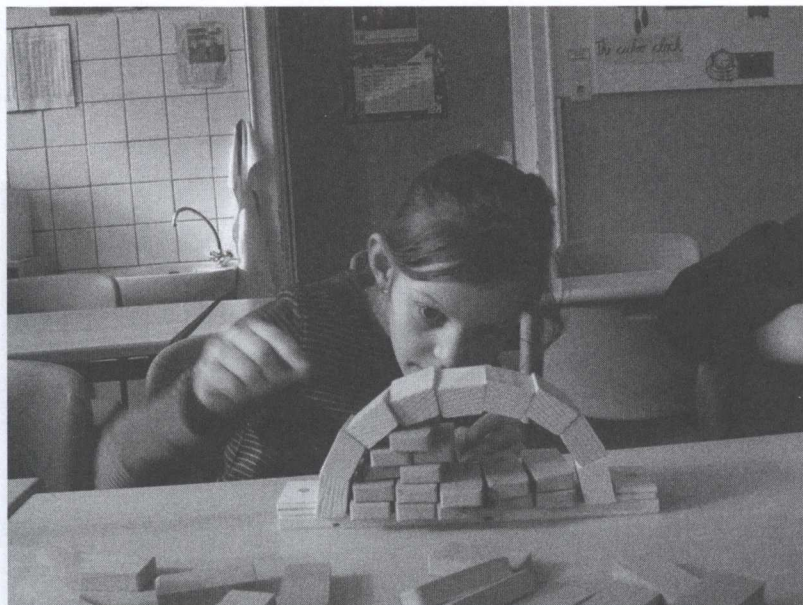
Bild 5: Die Lehre der Bogenbrücke wird abgebaut, der Bogen bleibt stabil stehen (links).
