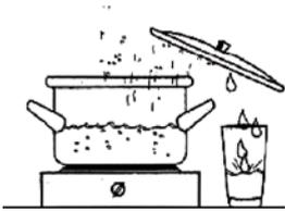
Eine Lehrkraft führt den oben dargestellten Versuch im Unterricht durch und erklärt daran, dass der Wasserdampf am kalten Deckel kondensiert. Dort bildet sich Niederschlag.
