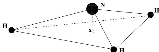
Betrachtet man die H-Atome als starres Dreieck, und das N-Atom in einem variablen Abstand  $x$  von der Mitte des Dreiecks, so kann die potentielle Energie approximativ durch
