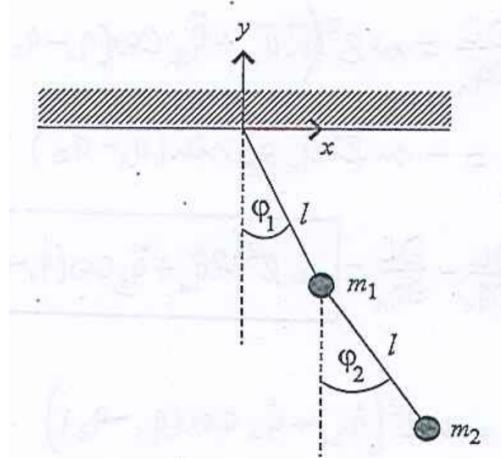
a) [2 P.] Stellen Sie für das abgebildete Doppelpendel mit  $m_1 = m_2 = m$  die Lagrange-Funktion in Abhängigkeit der Koordinaten  $q_1 = \varphi_1$ ,  $\dot{q}_1 = \dot{\varphi}_1$ ,  $q_2 = \varphi_2$ ,  $\dot{q}_2 = \dot{\varphi}_2$  auf. Das Pendel bewege sich unter dem Einfluss der Schwerkraft.
