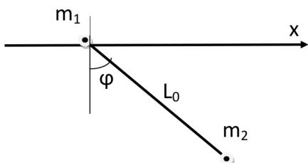
Betrachten Sie die Hantel (in der Skizze), die sich in der Zeichenebene bewegt. Die Hantel besteht aus zwei Massenpunkten  $m_1$  und  $m_2$ , von denen  $m_1$  reibungsfrei auf einer Schiene gleitet. Stellen Sie die Lagrange-Funktion in den generalisierten Koordinaten  $x$  (die Position des oberen Massenpunktes) und  $\varphi$  (siehe Skizze) auf. Bestimmen und lösen Sie die entsprechenden Lagrange'schen Bewegungsgleichungen.
