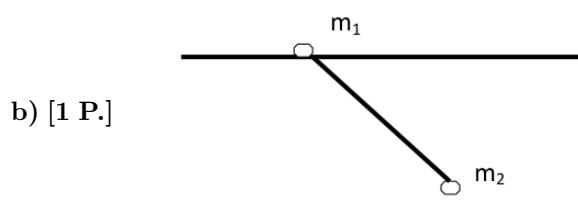
Eine Hantel (Länge  $L$ ) aus zwei Massenpunkten  $m_1$  und  $m_2$ , von denen  $m_1$  reibungsfrei auf einer Schiene gleitet.
