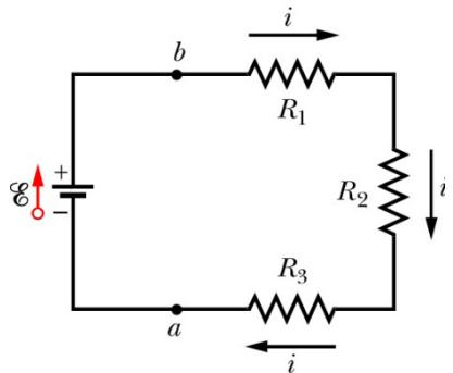
Legt man eine Potenzialdifferenz  $V$  an eine Reihenschaltung von Widerständen, so fließt durch jeden Widerstand der *gleiche Strom*  $i$ .
