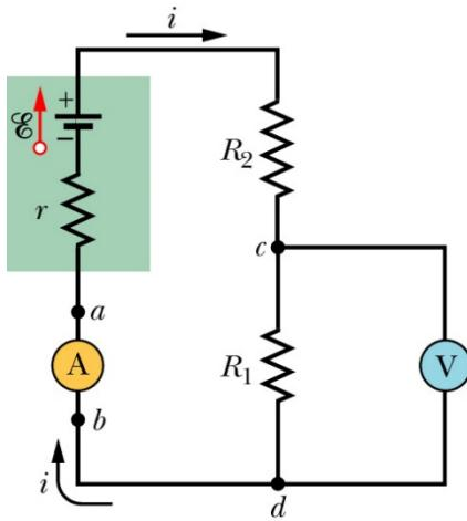
Ein Instrument zur Messung von Strömen bezeichnet man als Amperemeter. Um den in einer Leitung fließenden Strom zu messen, ist es normalerweise erforderlich, die Leitung zu unterbrechen und das Amperemeter in die Leitung einzuschleifen, sodass der zu messende Strom durch das Messgerät fließt.
