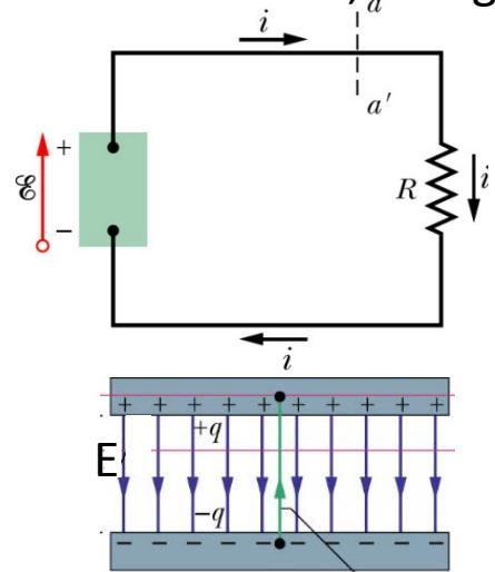
Innerhalb der Spannungsquelle bewegen sich positive Ladungsträger aus einem Bereich mit niedrigem elektrischen Potenzial/(pot. Energie) (- Pol) heraus in einen Bereich mit höherem elektrischen Potenzial/(pot. Energie) (+ Pol). Die Ladungsträger bewegen sich somit *entgegengesetzt* zu der Richtung, in die sie sich unter der Wirkung des elektrischen Felds zwischen den Polen der Spannungsquelle -welches vom positiven zum negativen Pol zeigt - bewegen würden.
