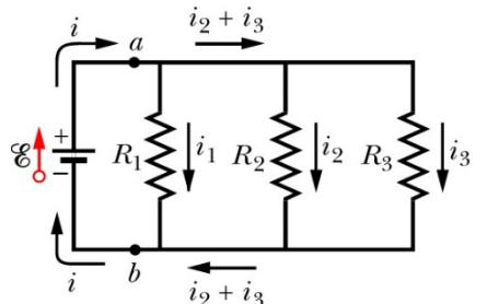
Legt man eine Potenzialdifferenz  $V$  an eine Parallelschaltung von Widerständen, so besteht über jeden der Widerstände die gleiche Potenzialdifferenz.
