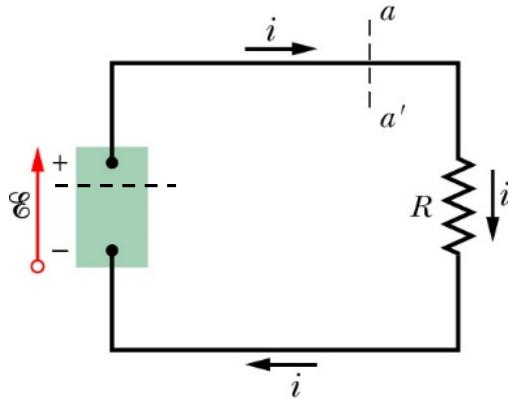
Es muss deshalb eine *Quelle von Energie* in der Spannungsquelle vorhanden sein, die Arbeit an den Ladungsträgern verrichtet, sodass diese sich vom (-) zum (+) bewegen können.
