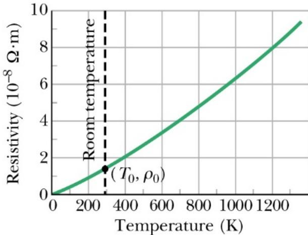
Die Temperaturabhängigkeit des spezifischen Widerstands von Metallen über einen recht großen Temperaturbereich ziemlich linear:
