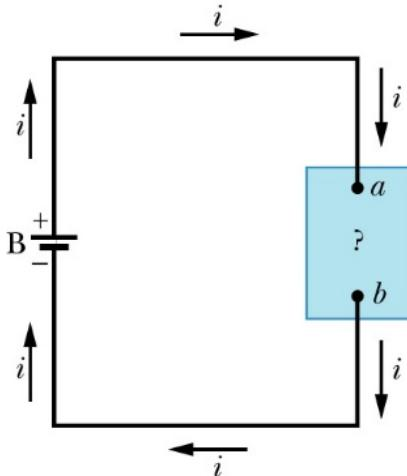
Die im infinitesimalen Zeitintervall  $dt$  zwischen den Anschlussklemmen des Bauteils transportierte Ladung  $dq$  ist gegeben durch  $i dt$ . Diese Ladungsmenge durchläuft einen Potenzialabfall vom Betrag  $V$ , sodass ihre elektrische potentielle Energie um einen Betrag abnimmt.
