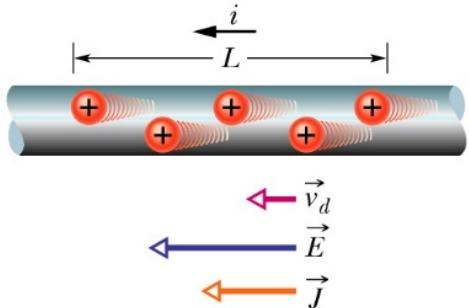
Ohne elektrisches Feld bewegen sich Leitungselektronen mit zufällig im Raum orientierten Geschwindigkeiten, sodass effektiv kein Ladungstransport in eine bestimmte Raumrichtung stattfindet. Auch im Fall eines äußeren elektrischen Felds ein Strom bewegen sich die Elektronen weiterhin ungeordnet.
