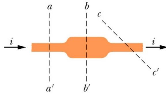
Der Wert dieses Stroms ist für alle Querschnittsflächen des Leiters gleich
