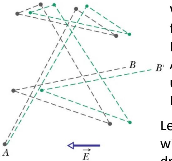
Wir nehmen an, dass sich die Leitungselektronen eines Metalls frei innerhalb des Metallvolumens bewegen können wie die Moleküle eines Gases in einem geschlossenen Behälter.
