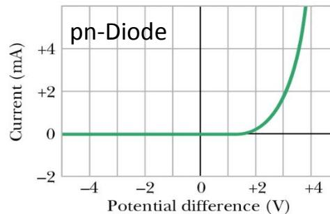
Anhand der Strom-Spannungs- $i(V)$ -Kennlinie eines leitfähigen Objekts erkennt man, mit welcher Art eines Leiters man es zu tun hat.
