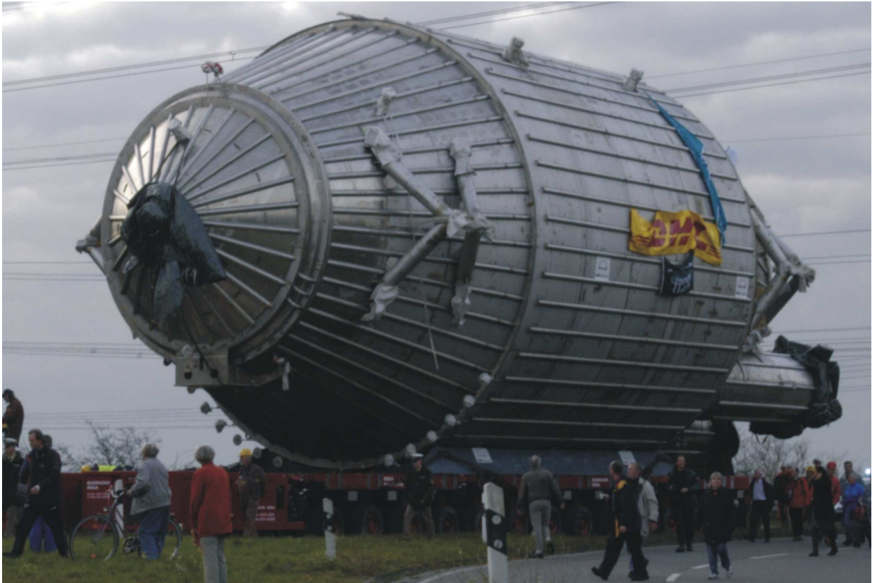
Abbildung 1.5.: Hauptspektrometer beim Transport. Dieses Foto zeigt den unverkleideten Vakuumtank des Hauptspektrometers beim Transport zum Forschungszentrum Karlsruhe.
