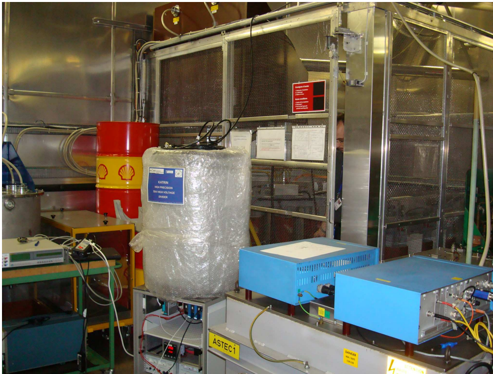
Abbildung 4.13.: Erster KATRIN-Spannungsteiler auf der ISOLDE-Erzeugungsplattform. Zu sehen ist der erste KATRIN-Spannungsteiler auf der ISOLDE-Erzeugungsplattform. Zu sehen sind außerdem das Fluke 8508A Multimeter auf der linken Seite, das Astec1 Netzteil rechts im Vordergrund und der Hochspannungskäfig aus dem die Ionen beschleunigt werden im Hintergrund.
