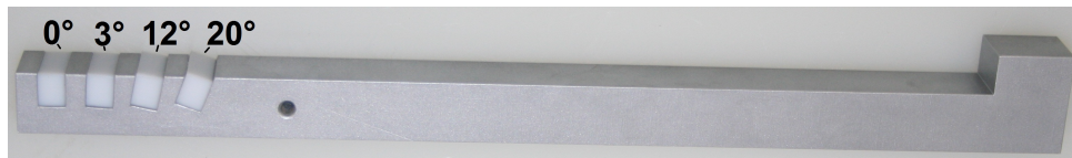
Abbildung 2.4.: Die Halterung für die Teflontargets für erste Messungen.
