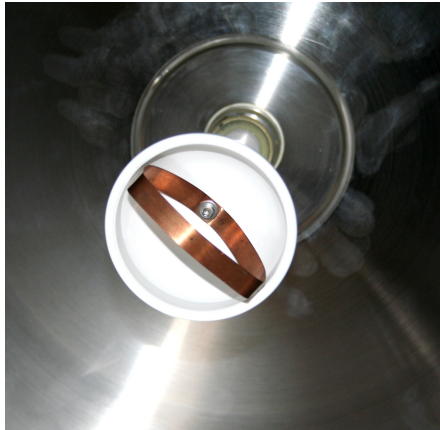
Abbildung 2.6.: Hochspannungszuführung der ersten Generation. Hier ist das alte Konzept der Hochspannungszuführung gezeigt. Die Bronzefeder stellt den Kontakt zwischen der Hochspannungsbuchse und der Kupferelektrode her.
