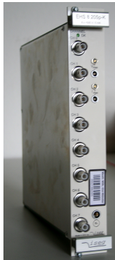
Abbildung 5.4.: ISEG Modul EHS 8205-505p_K_SHV . Diese Abbildung zeigt eines der Module die der Versorgung der Drahtelektrode mit Hochspannung dient. Auf der Vorderseite sind die HV-Ausgänge zu sehen, sowie die Potentiometer zur Begrenzung von Ausgangsstrom und -spannung
