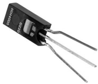
Abbildung 2.4.: Feuchtigkeitssensor. Hier ist eine Abbildung des verwendeten Feuchtigkeitssensors mit den drei Anschlüssen zu sehen [Hon06].
