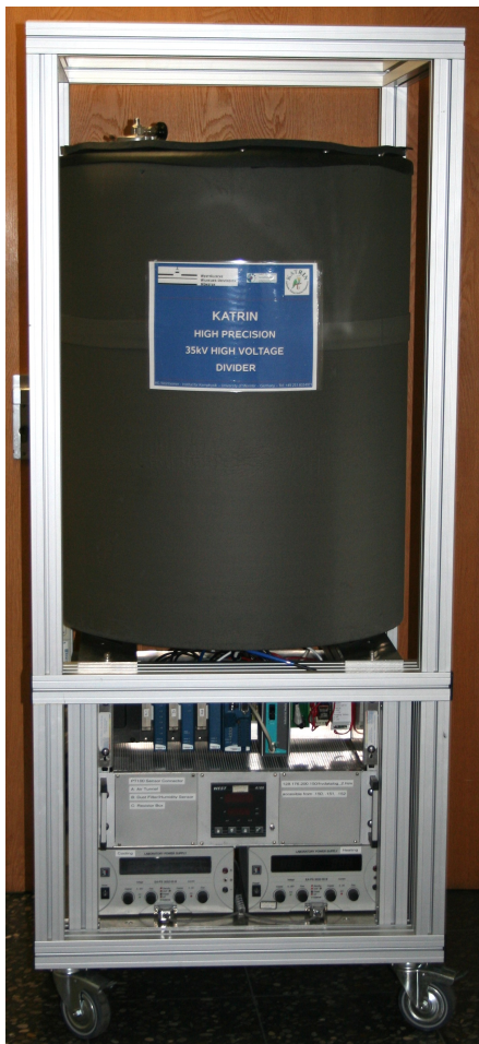
Abbildung 2.10.: Der KATRIN Hochspannungsteiler nach den Modifikationen. Gezeigt ist der KATRIN Spannungsteiler nach den Umbauten. Der Aluminiumrahmen macht ihn stabil und gleichzeitig mobil. Im unteren Teil sieht man den WEST PID regler sowie die Netzteile zum heizen und Kühlen und den Compact Fieldpoint mit den Messkarten.
