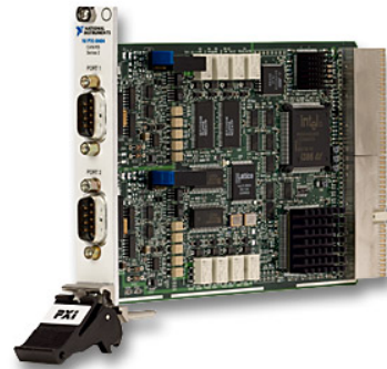
Abbildung 5.12.: CAN-Schnittstelle NI PXI 8464. Hier ist eine Abbildung der CAN-Schnittstellenkarte zu sehen. An der Vorderseite sind die beiden Kanäle zu erkennen. Der Anschluss wird mit einem neunpoligen Sub-D Stecker hergestellt [CAN25].
