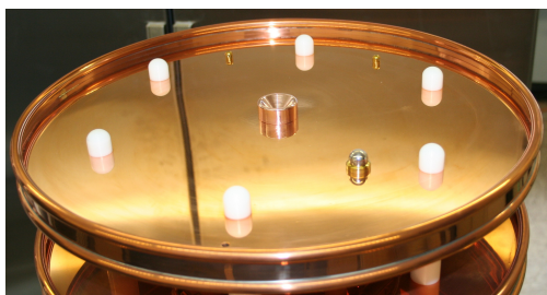
Abbildung 2.8.: Modifikation der obersten Kupferelektrode. Diese Abbildung zeigt die oberste Kupferelektrode nachdem das konische Gegenstück für die neue HV-Zuführung montiert wurde.
