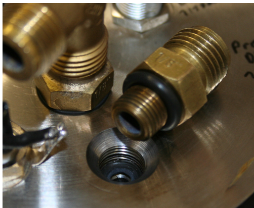
Abbildung 2.11.: Abdichtung der Leckstelle In diesem Bild erkennt man die neue Senkung an der Bohrung sowie den Dichtring an der Verschraubung.
