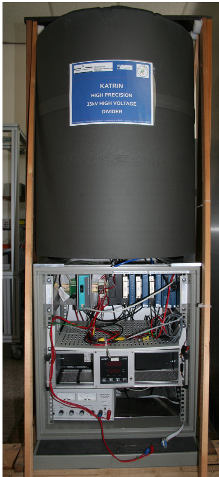
Abbildung 2.1.: Spannungsteiler vor den Umbauarbeiten. Hier ist der Aufbau des KATRIN Spannungsteilers vor den Modifikationen gezeigt. Der Holzrahmen und der Unterbau wurden komplett entfernt und ein neues Gehäuse aufgebaut.
