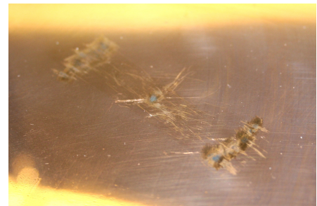
Abbildung 2.5.: Überschlagsspuren auf der obersten Kupferelektrode. In diesem Bild erkennt man deutlich die Spuren aus Überschlügen von der Hochspannungszuführung auf die Kupferelektrode.
