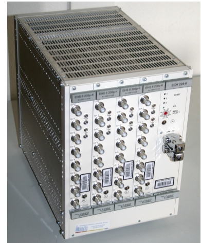
Abbildung 5.5.: ISEG Überraahmen mit vier eingebauten Modulen. Der ISEG Überraahmen hat die Breite von 1/2 19-Zoll und kann vier einzelne Module aufnehmen. Die Versorgungsanschlüsse sind auf der Rückwand, während an der Vorderseite die Ausgänge der einzelnen Module und die CAN Schnittstelle angebracht sind.
