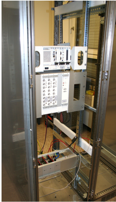
Abbildung 6.11.: Testaufbau für die Versorgungsschaltung. Im Testaufbau wurden das PXI-System und der ISEG-Überrahmen mit drei Netzgeräten die die isolierte Box eingeschraubt und auf ein höheres Grundpotenzial von 1 kV angehoben.
