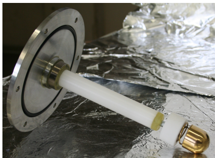
Abbildung 2.7.: Hochspannungszuführung der zweiten Generation. Hier ist das neue Konzept der Hochspannungszuführung gezeigt. Die vergoldete Halbkugel wird über eine Spiralfeder mit der Hochspannungsbuchse verbunden. Das konische Gegenstück wird auf der Kupferelektrode montiert. Beim Aufsetzen des Deckels pressen beide Teile ineinander und stellen den Kontakt her.
