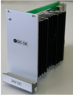
Abbildung 5.15.: Modul für die 24 V-Versorgung. Dieser Abbildung zeigt ein Modul, wie es für die 24 V-Versorgung aufgebaut wurde
