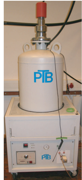
Abbildung 6.1: Referenzspannungsteiler MT100 der PTB. Gezeigt ist der Referenzspannungsteiler bis 100 kV mit der Bezeichnung MT100. Der eigentliche Spannungsteiler ist in einem, mit SF 6 -Gas gefülltem, Druckbehälter untergebracht. Um linken unteren Bereich ist die Temperaturanzeige und Steuerung zu sehen. Rechts daneben befinden sich die Anschlüsse der Präzisionsabgriffe. Die Maßstabsfaktoren sind 100:1, 3333:1 und 10000:1.
