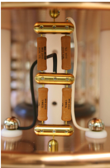
Abbildung 5.3: Konfiguration der Abgriffwiderstände des Steuerteilers. Gezeigt sind die Abgriffwiderstände des Kontrollteilers mit dem durch den externen Schalter erdbaren Punkt zwischen den zwei parallelen Paaren. Das weiße Kabel ermöglicht den Abgriff sowohl für den Steuerteiler als auch für den Tastkopf. Das schwarze Kabel kann über den Kurzschlussstecker mit der Erde kurzgeschlossen werden.
