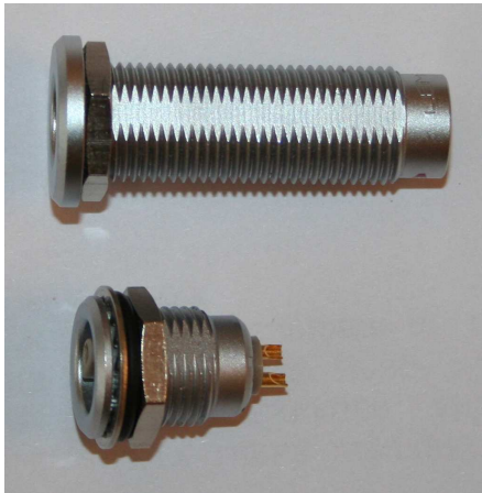
Abbildung 5.5: Durchführungen der Präzisionsabgriffe. Gezeigt sind die zweipoligen Durchführungen der Präzisionsabgriffe. Oben die vakuumtaugliche Variante als Durchführung (beidseitige Aufnahme für Stecker). Unten die im Spannungsteiler verwendeten Gerätebuchsen (eine Steckeraufnahme+Lötkontakte)
