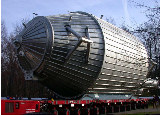
Abbildung 1.6: KATRIN Hauptspektrometer. Gezeigt ist das Hauptspektrometer mit einem Durchmesser von 10 m und einer Länge von 23,3 m während des Transports an das Forschungszentrum Karlsruhe.
