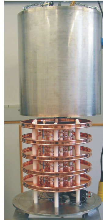
Abbildung 1.9: Der erste KATRIN Spannungsteiler. Gezeigt ist das Schaltbild des Spannungsteiler, wobei die Widerstände der Primärkette zu vier Widerständen zusammen gefasst sind (links) und der geöffnete Spannungsteiler, bei dem der innere Aufbau gut zu sehen ist (rechts).
