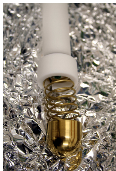
Abbildung 5.2: Hochspannungszuführung. Abgebildet ist die Spiralfeder mit der montierten Halbkugel und dem innenliegenden Kupfergeflecht. Die Hochspannungszuführung ist fertig an der Hochspannungsbuchse (nicht vollständig sichtbar) montiert.
