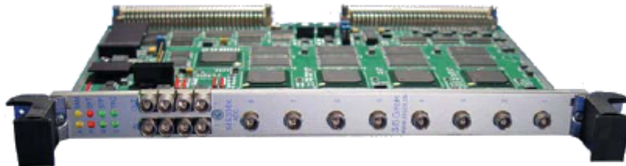
Abbildung 3.4: SIS3301 FADC Modul Abgebildet ist ein Modul des Typs SIS3301-105, welches in dem MiniPET Experiment verwendet wird.
