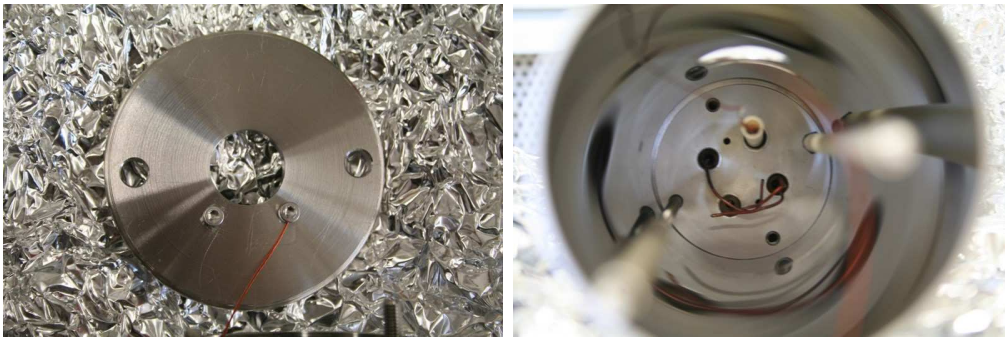
Abbildung 4.18.: links: Blick auf die Linse mit festgeklemmtem Draht; rechts: geöffnetes Rohr mit HV-Durchführung des Flansches
