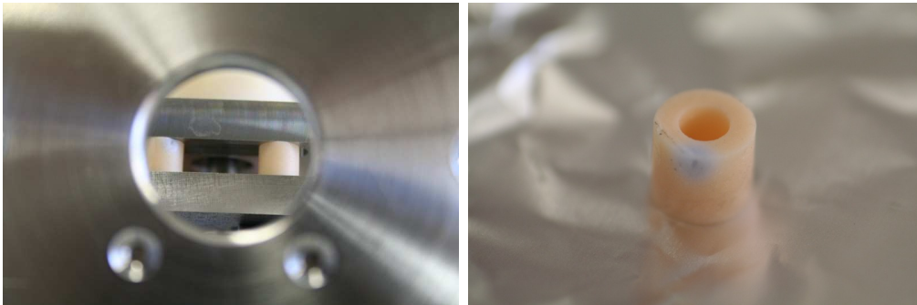
Abbildung 4.31.: links: Platten-Setup mit halben Keramiken; rechts: Keramik mit Metallfilm
