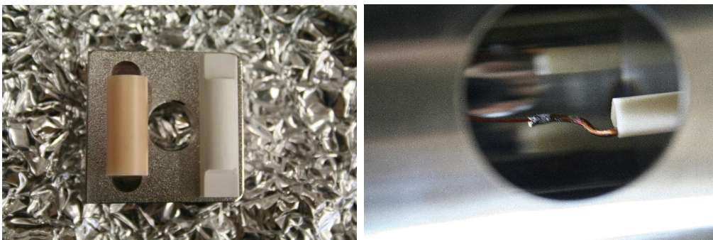
Abbildung 4.24.: links: Alte und neue Keramik im Vergleich; rechts: Blick durch die hintere Öffnung des Rohrs auf den Kupferdraht der HV-Durchführung
