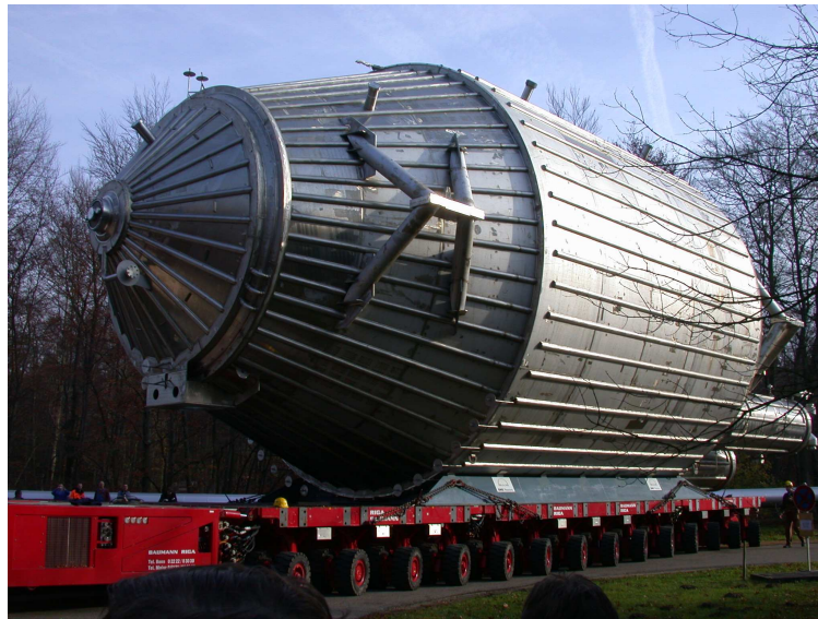
Abbildung 2.4.: Hauptspektrometer beim Transport. Dieses Foto zeigt den unverkleideten Vakuumtank des Hauptspektrometers während des Transports auf dem Gelände des KIT. [Val06]
