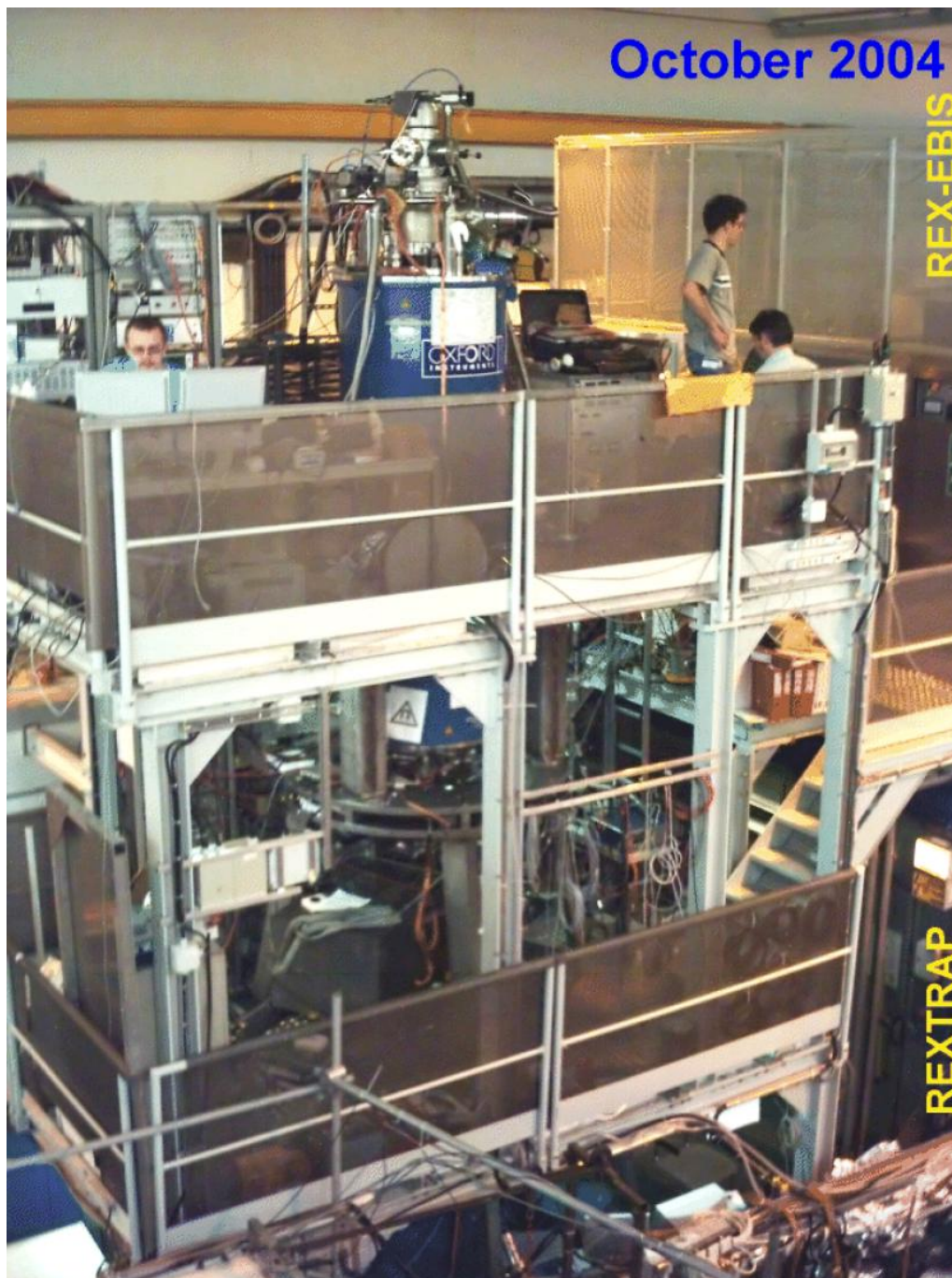
Abbildung 3.2: Fotografische Aufnahme des WITCH-Aufbaus: Gezeigt ist eine Seitenansicht des WITCH-Aufbaus aus dem Jahr 2004, nachdem alle Komponenten aufgebaut waren. Rechts unten befindet sich REXTRAP (aus [Koz05]).
