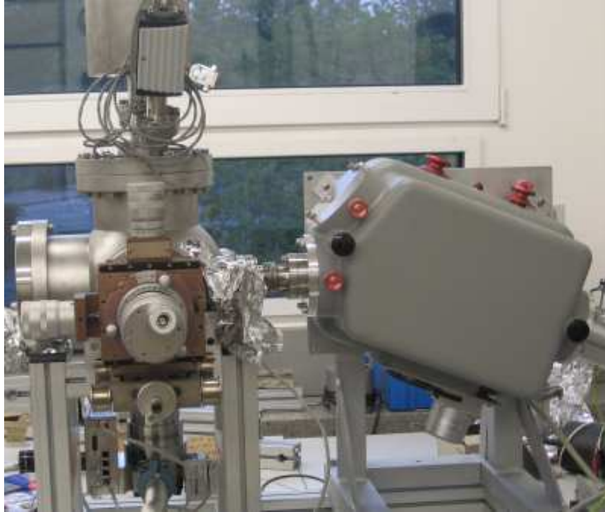
Abbildung 4.1.: Realisierung des technischen Aufbaus. Links im Bild ist der Vakuumaufbau zu sehen, dieser ist auf der rechten Seite mit dem McPherson Vakuummochromator verbunden.
