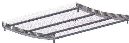
Abb. 2.10: Schematische Abbildung eines Drahtelektrodenmoduls.
