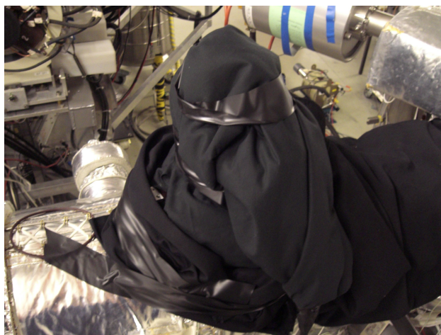
Abb. 6.8.: Hier ist der montierte CPM-K am ESR über der Spiegelstrecke zu sehen. Damit kein Licht ein- dringt wurde der Detektor in schwarze Stoffdecken gehüllt.
