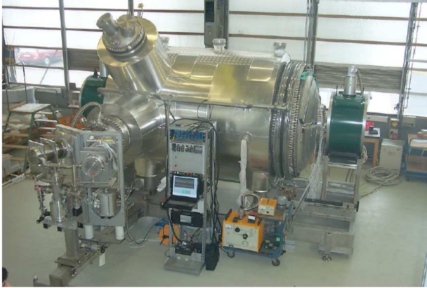
Abbildung 3.6.: Das ca. 3,4 m lange Vorspektrometer ; Es schließt sich der Transportsektion an und dient dazu niederenergetische Zerfallselektronen zu reflektieren.(Abbildung aus [KAT04])
