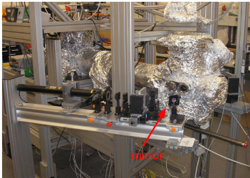
Abbildung 6.2.: Ellipsometrie-Aufbau mit einem Spiegel ; Er befindet sich zwischen Kompensator und Substrat, ansonsten wurden am alten Aufbau keine Veränderungen vorgenommen.
