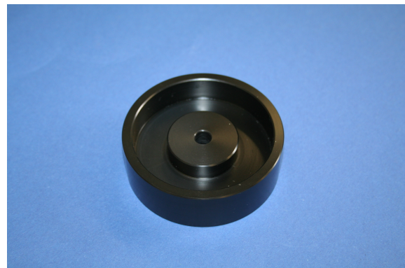
Abbildung 3.7: POM-Halterung (Polyoxymethylen) für die UV-Diode.
